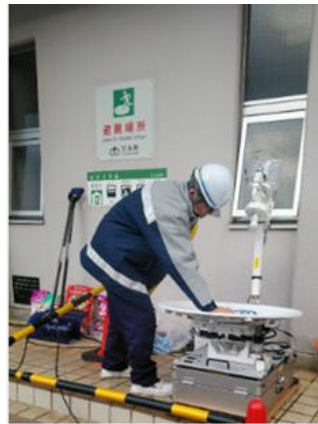
ポータブル衛星電話を 設置している様子
